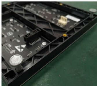
将磁柱安装在模組上
