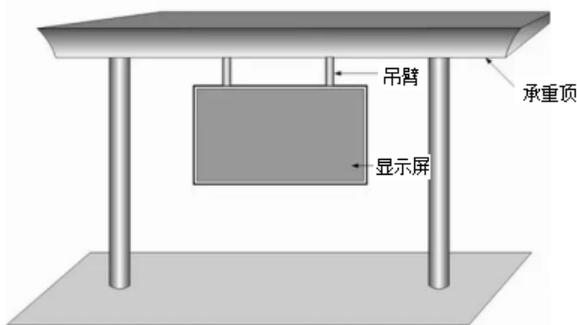
此安装方式与悬臂式安装方式类似，屏体采用一体柜设计方案。
