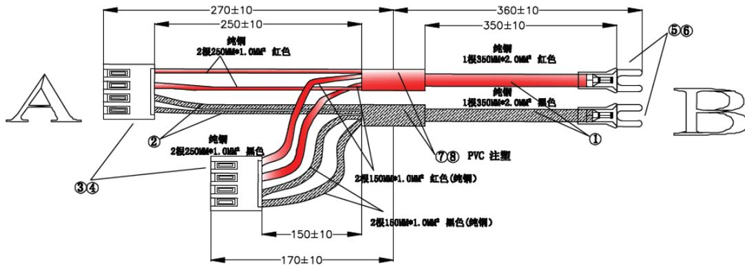
电源线型号：一拖二-60cm-25cm/15cm VH 压线式条形连接线<纯铜>
